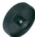
In materiale sintetico. Con vite di fissaggio. Circonferenza mm 200, diametro mm 64, larghezza fascia mm 17, diametro foro attacco mm 6. Da applicare ai contametri Art. 4445 GA-B.
